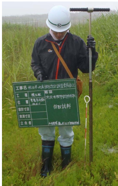
写真-17.4.1.1 検土杖による掘削風景
