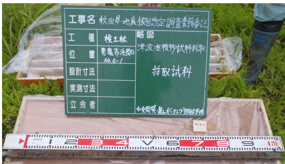
写真-17.4.1.2 検土杖による試料採取
